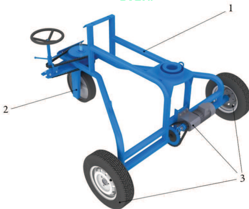
Рис. 6 Рама с ходовой частью. 1-рама; 2- ход передний; 3-ход задний;
