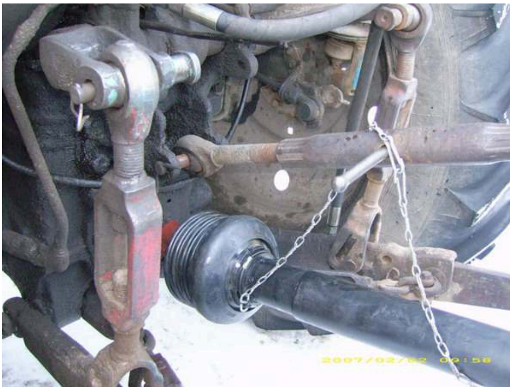
Рис. 3 – Схема крепления телескопического вала.
