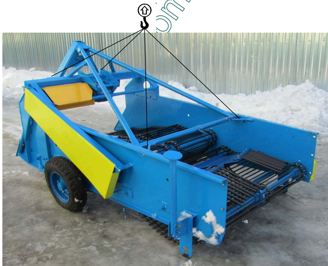
Рис. 5 – Схема строповки картофелекопателя.
