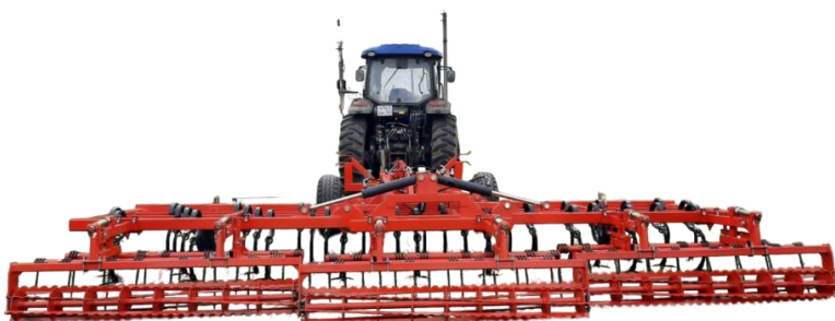
стойка 45x12 с подпружинником, лапа 250мм
